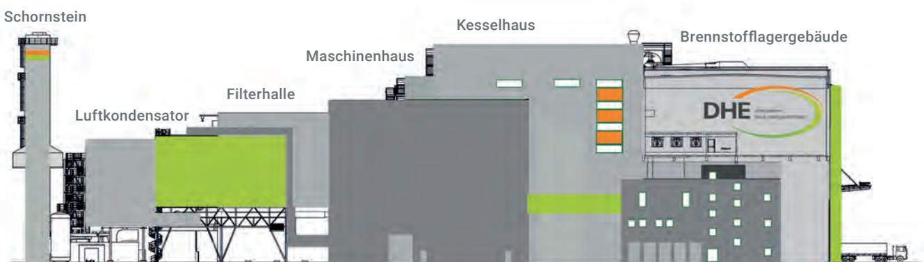
Das Altholz für das DHE wird von spezialisierten Unternehmen außerhalb von Dinslaken aufbereitet, per LKW angeliefert und vom Fahrzeug direkt in den mit einer Absauganlage versehenen Bunker gegeben. Von dort bringt es die Krananlage auf einen der beiden beweglichen Vorschubroste, auf denen die thermische Verwertung geschieht. Von unten wird Luft zugeführt und Asche abgeführt. Nach oben
